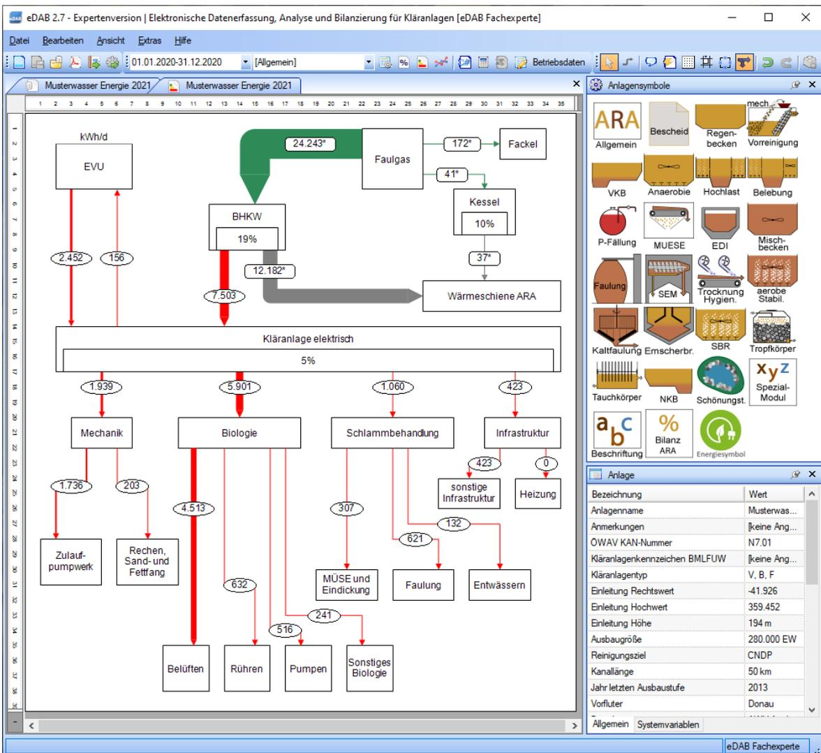
Die Option **Energiebilanz** umfasst die Visualisierung der Energieströme (Abbildung) inklusive Vorlage für einen aussagekräftigen Standard-Energiebericht (ein Muster kann angefordert bzw. auf [www.edab.at](http://www.edab.at) eingesehen werden) und kann als neue eDAB-Option erworben werden.
